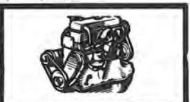
Motor mit angeflanschtem Getriebe nach oben ausbauen.
